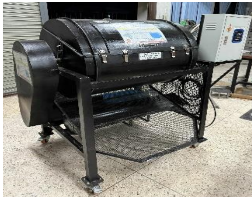
ภาพที่ 9 เครื่องล้างดินออกจากฝักถั่วลิสงที่สร้างขึ้น
