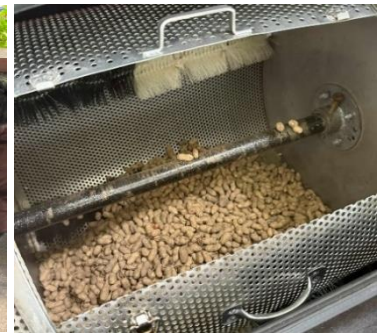
(ค) การล้างดินออกจากฝักถั่วลิสงด้วยเครื่องล้างดินที่สร้างขึ้น
