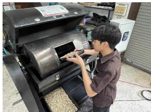
(ข) การคั่วถั่วกับทรายด้วยเครื่องที่ออกแบบและสร้างขึ้น
