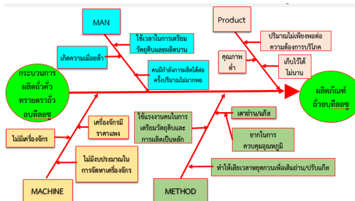
ภาพที่ 2 แบบจำลองการวิเคราะห์ปัญหาที่เกิดขึ้นในกระบวนการผลิตถั่วคั่วทราย ถั่วอบที่ล่อชูอุ่มฝางของกลุ่มวิสาหกิจชุมชนถั่วคั่วทรายบ้านหนองหลวง
