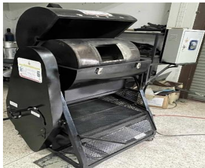
ภาพที่ 6 เครื่องคั่วถั่วกับทรายที่สร้างขึ้น
