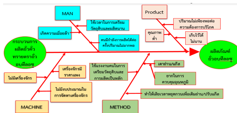
ภาพที่ 2 แบบจำลองการวิเคราะห์ปัญหาที่เกิดขึ้นในกระบวนการผลิตถั่วคั่วทราย ถั่วอบที่ล่อชูอุ่มฝาง ของกลุ่มวิสาหกิจชุมชนถั่วคั่วทรายน้องหลวง
